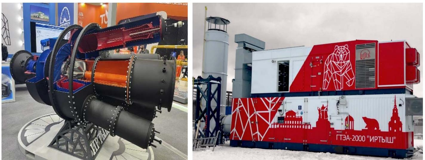
Агрегат обладает целым рядом преимуществ: многотопливность (природный газ, попутный газ, нефть – без необходимости дополнительной подготовки и очистки); удлиненный межремонтный период (за счет простоты и уникальности конструкции); блочно-модульное исполнение (в блоках высокой степени заводской готовности); мобильность (транспортировка тремя обычными трейлерами и монтаж на проектной площадке за 48 часов); отсутствие необходимости устройства фундамента (лишь
